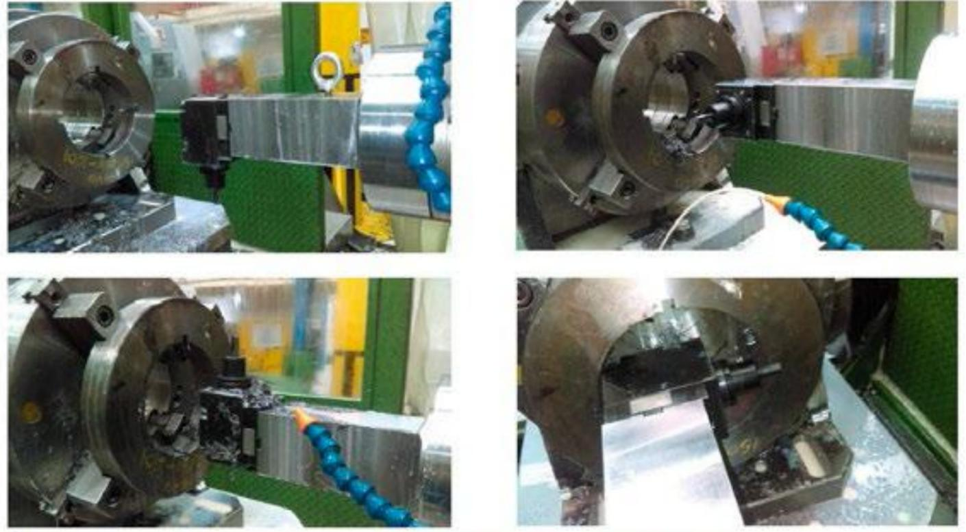
4 Posiciones de cabezal angular para mecanizado de ranuras internas equidistantes.
