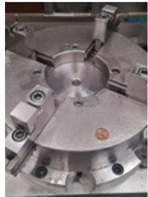
Nuevo setting mandrel rotador con sistema de trinquete.
