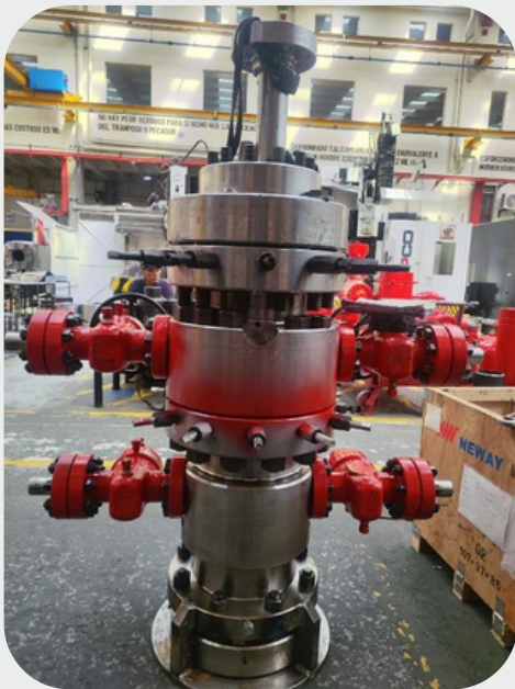
Prueba de ensamble monobloque
