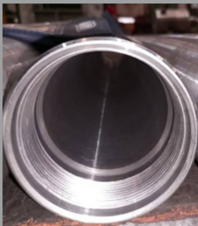
Ilustración 2 Alesado de piezas y tool, body regist y telescopic.
