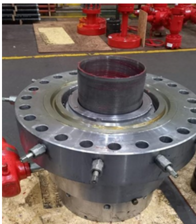
Ilustración 1 Riser System 30 outlet 16 flowline X.
