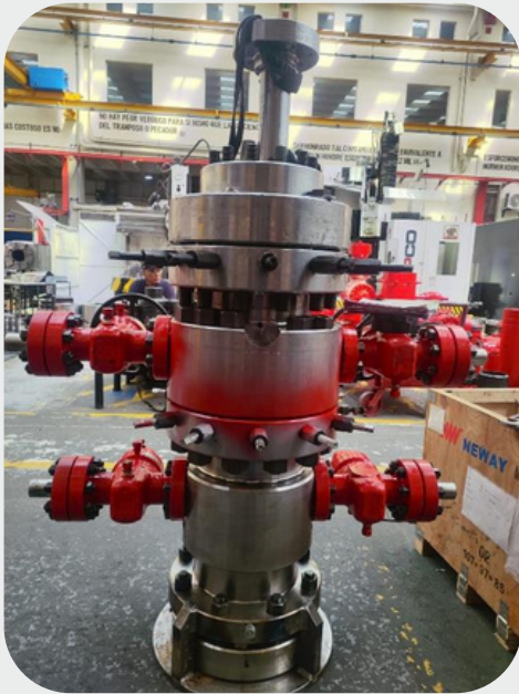
Prueba de ensamble monobloque
